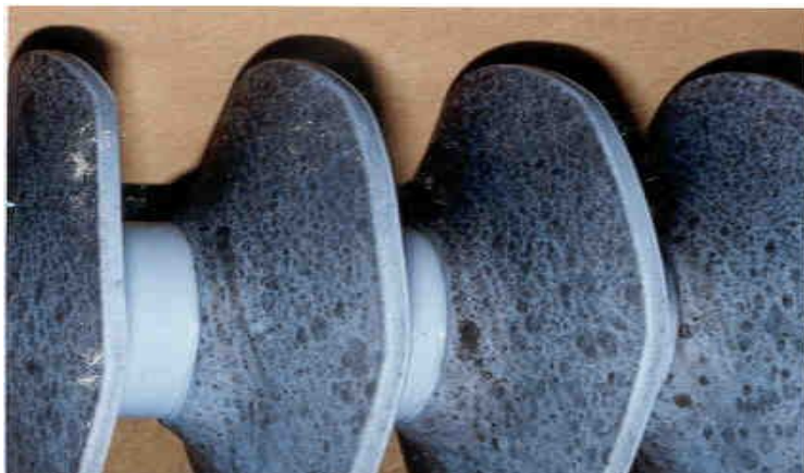
Рис. 3.15. Ізолятор, пошкоджений пліснявою
