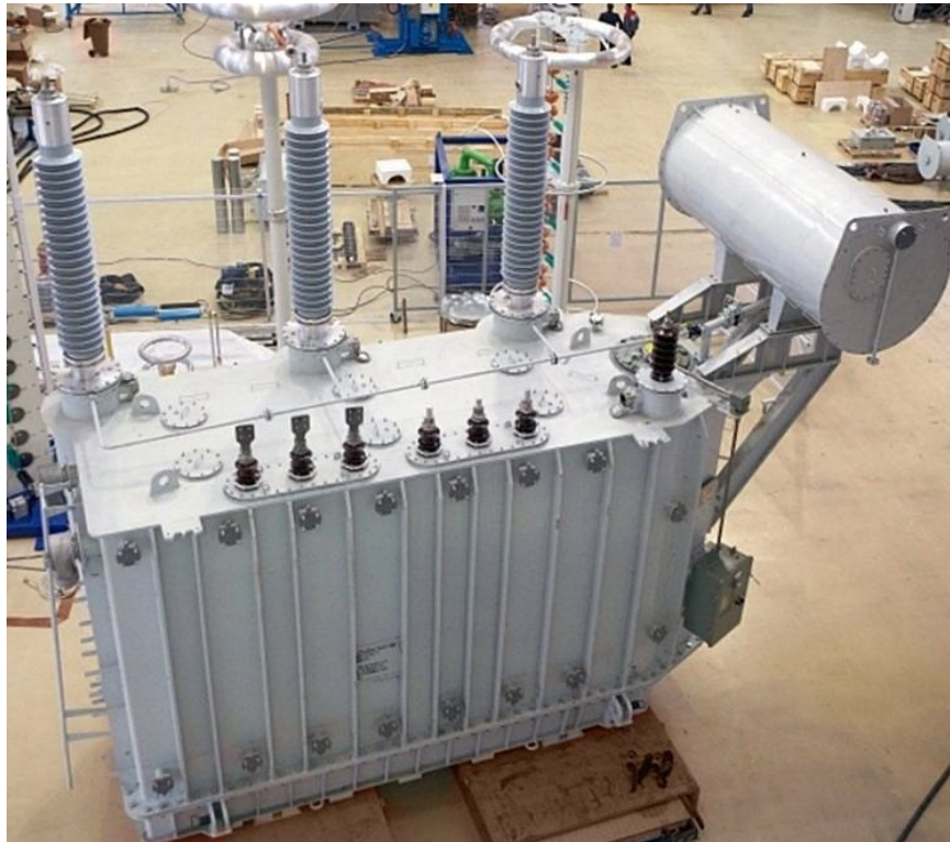
Рис. 4.17. Загальний вигляд двообмоткового силового трансформатора з розщепленою вторинною обмоткою типу ТРДН -40000/110/10/10
