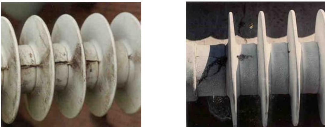
Рис. 3.27. Наслідки поверхневого пробію полімерного покриття ізолятора
