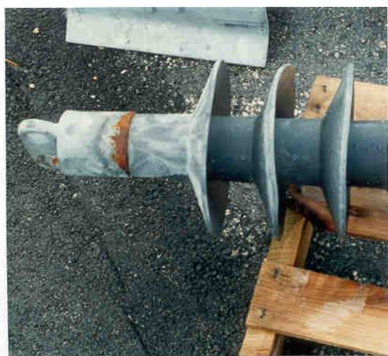
Рис. 3.18. Пошкодження наконечників унаслідок горіння дуги
