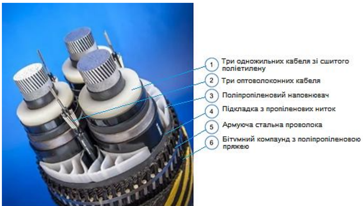
Рис. 3.43. Конструкція кабелю з ізоляцією зі зшитого поліетилену: a – одножильний підземного прокладання; б – трьохжиильний морського прокладання
