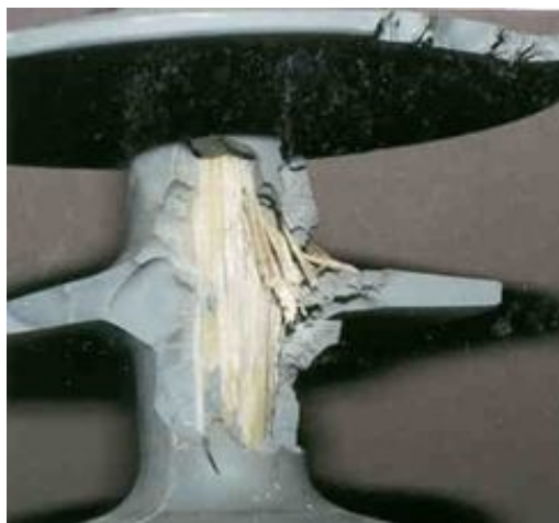
Рис. 3.21. Пошкодження утримуючого склопластикового стрижня
