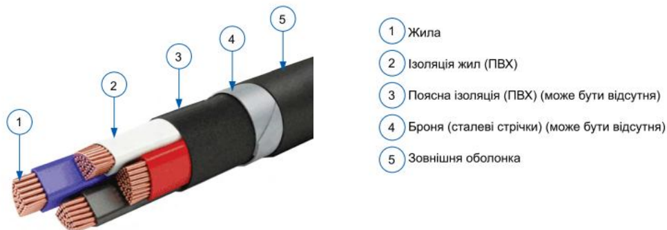
Рис. 3.40. Кабель із ПВХ-ізоляцією та неекранованими жилами
