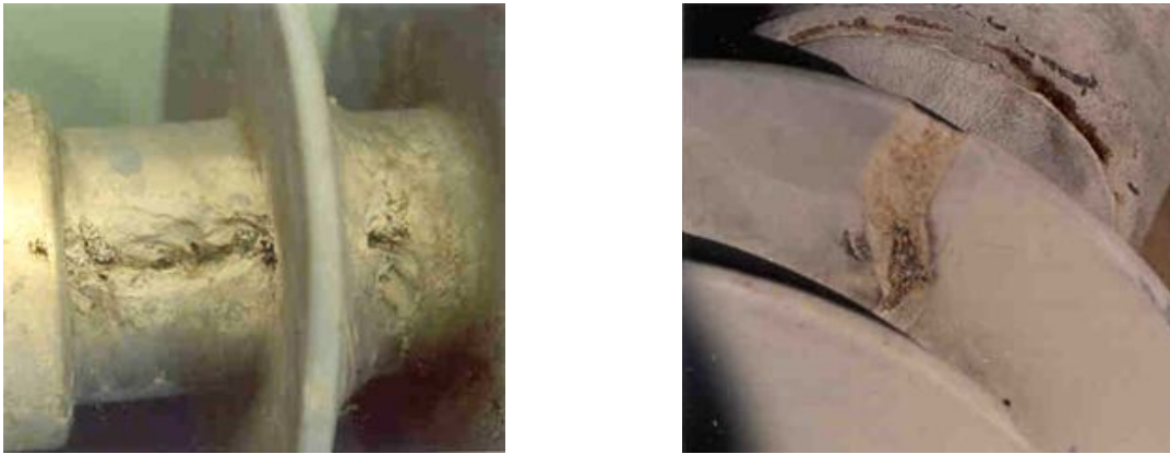
Рис. 3.26. Поверхнева ерозія полімерного покриву
