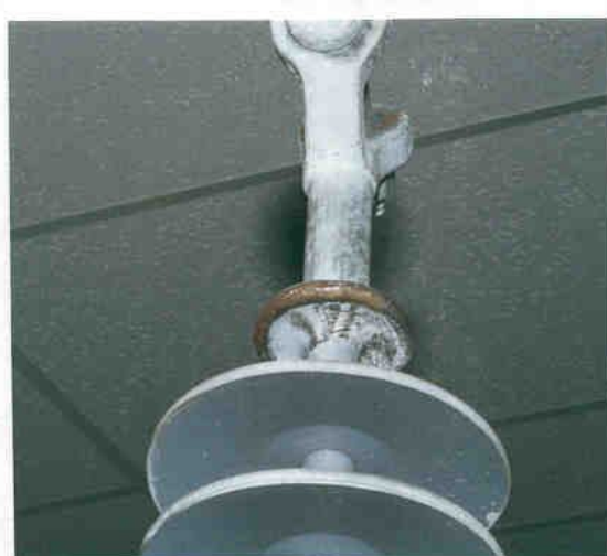
Рис. 3.18. Пошкодження наконечників унаслідок горіння дуги
