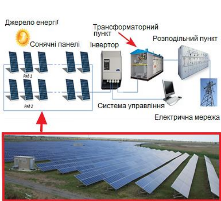
Рис. 5.12. Сонячна електрична станція: a – безпосереднього перетворення; б – теплофікаційна (17 000 дзеркал, 165-метрова башта з парогенератором, T = 566\text{ }^{\circ}\text{C} )
