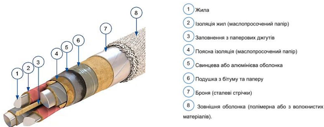
Рис. 3.42. Кабель з паперовою маслопросоченою ізоляцією з неекранованими жилами
