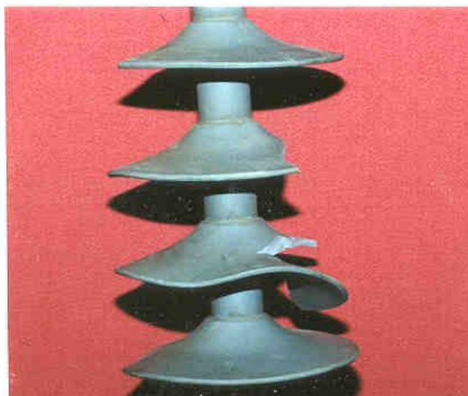
Рис. 3.17. Ізолятор із незначними механічними пошкодженнями
