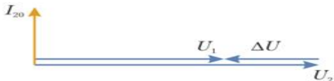
б) векторна діаграма напруги та струму режиму неробочого ходу
